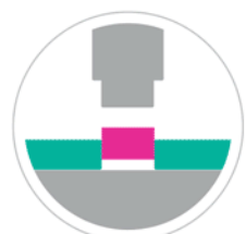
押圧嵌め、設置
