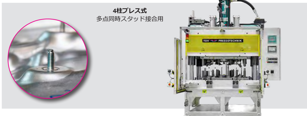
独立Cフレームx4式装置 ナットカシメ専用機
