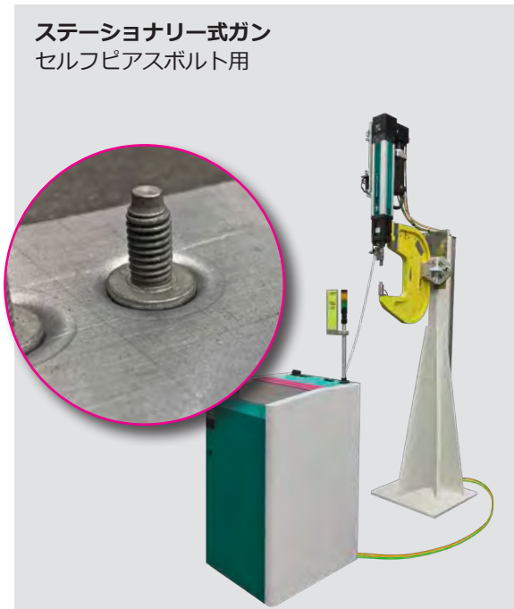
Cフレーム式プレス設備 手動ワークセット 車両フード部品へ リベットボルトの接合用
