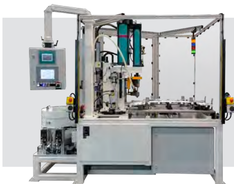
Cフレーム式プレス設備 手動ワークセット 車両フード部品へ リベットボルトの接合用
