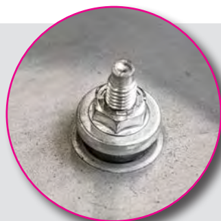
4柱式プレス設備 ホイールアーチ部品への グランドスタッドの接合
