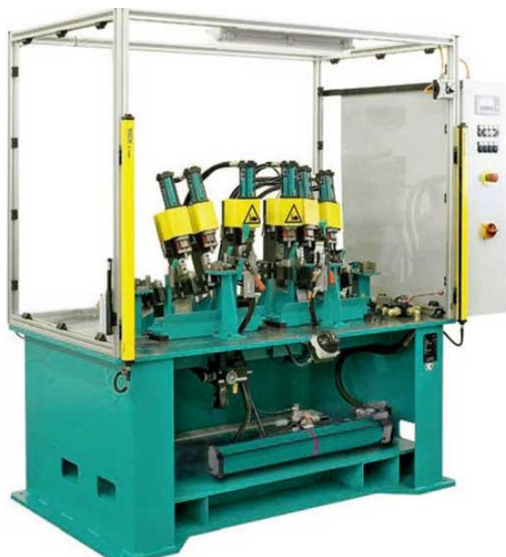
TOX ® -パワーパッケージ X-KT-システムで加圧： 1 台の増圧器と 6 個のドライブシリンダ
