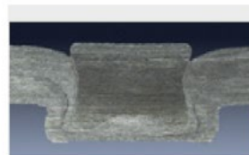
クリンチリベット ® 接続の断面
